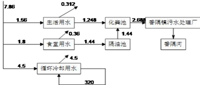
本项目水平衡图 (t/d)
